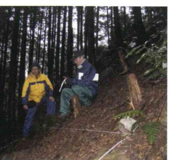
●斜面の勾配を、傾斜角度計で測ります。
