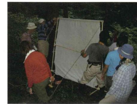
●日没の前にライトトラップを設置します。フレームを立ててシートを張ったら、ライトを点灯して夜まで置いておきます。
